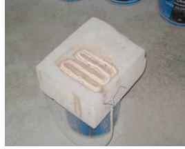
İptidai seyyar lamba Uygun seyyar lamba Tuğlaya rezistans teli Elektrik tellerinden uzak
