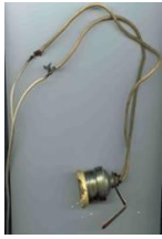
İptidai seyyar lamba Uygun seyyar lamba Tuğlaya rezistans teli Elektrik tellerinden uzak
